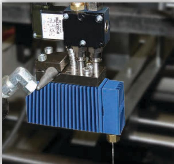
La serie de aplicadores MK-F ofrece la posibilidad de trabajar con 2 opciones de módulos: cordón y cavidad cero. Los mini módulos cordón son fácilmente adaptables a boquillas fijas, 90° y esféricas. Los mini módulos de cavidad cero proporcionan un patrón de aplicación extremadamente preciso para velocidades de trabajo muy altas, y con cualquier tipo de adhesivo.
